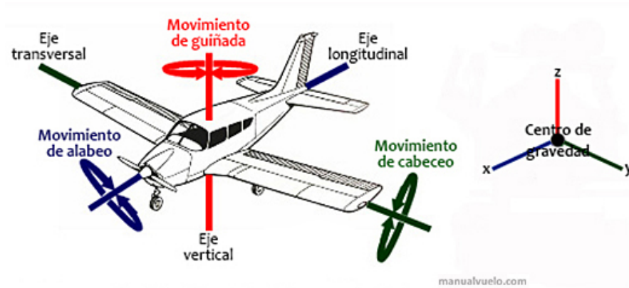
Fig.151 - Ejes del avión y movimientos sobre ellos.
